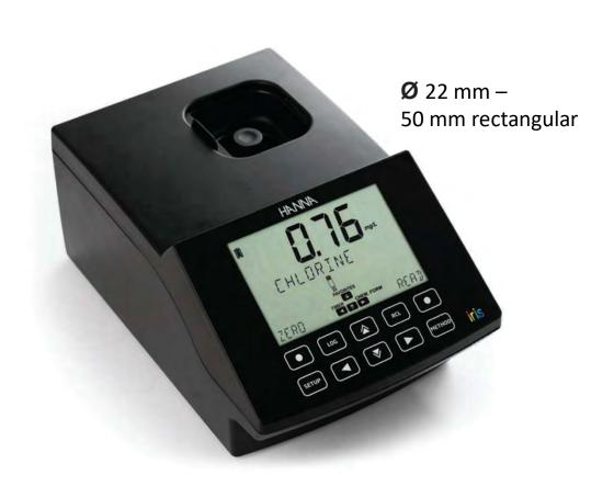
Posibilidad de distintas cubetas con distintas longitudes del camino óptico mediante adaptadores.
