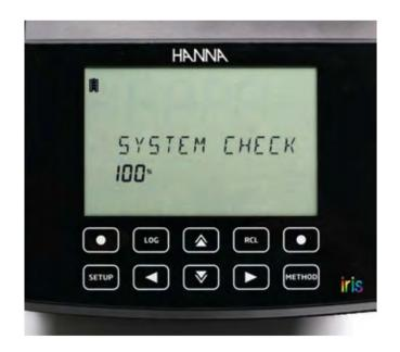
El chequeo óptico automático al iniciar el equipo para el aseguramiento de la calidad de la medida óptica, antes de las medidas.
